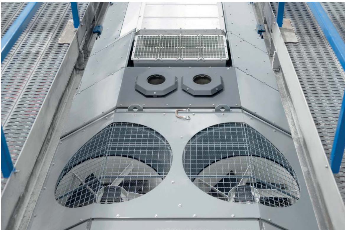
Dachkühlanlage für Lokomotive
